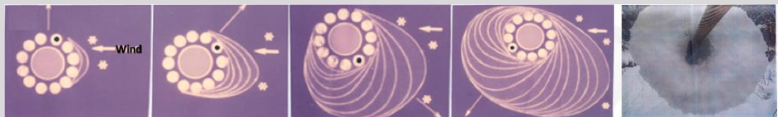
Figura 6- Formazione manicotto di neve umida
